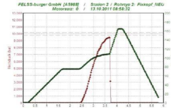
2号管件 9464bar 爆破压力图 Tube 2 with 9464 Bar burst pressure
